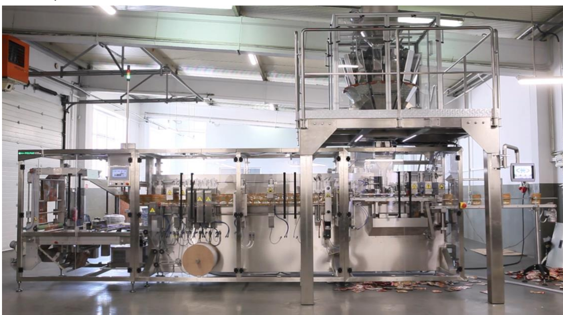
Rysunek 7 – Zdjęcie maszyny do produkcji opakowań typu saszetka z folii (źródło: materiały własne)
