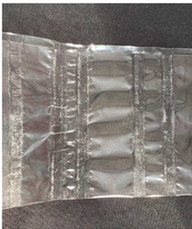
Rysunek 4 – Przykładowe defekty saszetek w postaci przegrzania krawędzi zgrzewanych (źródło: materiały własne)
