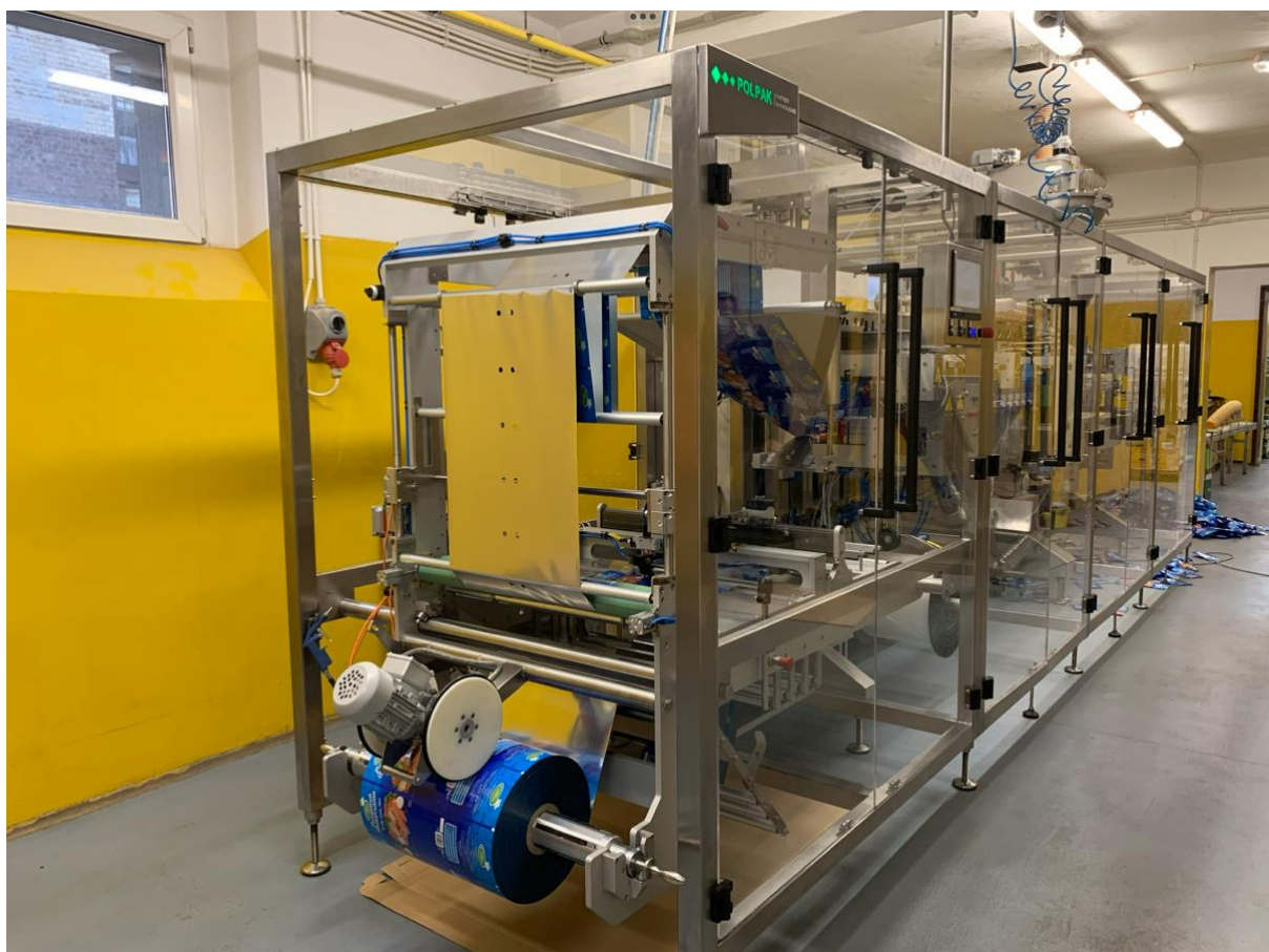
Rysunek 8 – Zdjęcie maszyny do produkcji opakowań typu saszetka z monofolii (źródło: materiały własne)
