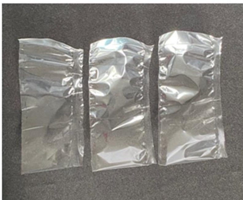
Rysunek 6 – Przykładowe defekty saszetek w postaci skrócenia krawędzi zgrzewanych (źródło: materiały własne)
