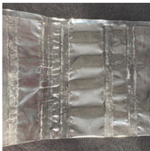
Rysunek 4 – Przykładowe defekty saszetek w postaci przegrzania krawędzi zgrzewanych (źródło: materiały własne)
