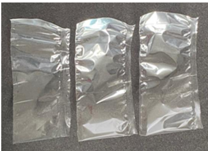
Rysunek 6 – Przykładowe defekty saszetek w postaci skrócenia krawędzi zgrzewanych (źródło: materiały własne)
